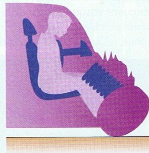
fig. 11c Les éléments de la voiture (volant, moteur...) pénètrent dans l'habitacle et viennent blesser les occupants du véhicule.
