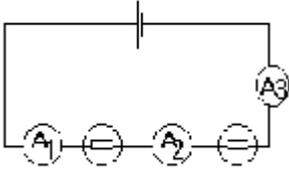
Voici un circuit en série. Plusieurs mesures d'intensité sont réalisées.
